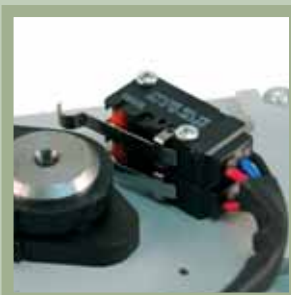
Fins de courses électromécaniques d'ouverture et de fermeture incorporés.
