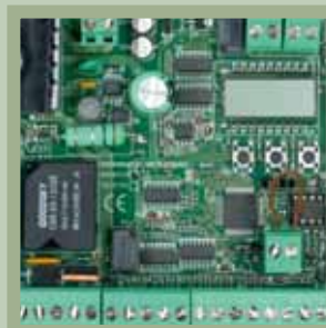
Centrale de commande, BRAINY24 24Vdc, avec programmation par afficheur à cristaux liquides intégré
